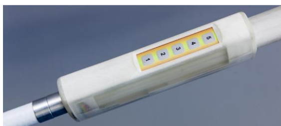
Obr. 4: Konstrukce řešení interface slepecké hole s jedním polem s 5 tlačítky
